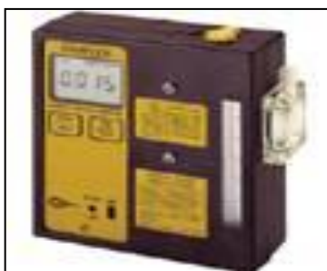
ภาพที่ 4-4 ตัวอย่างปั๊มเก็บตัวอย่างอากาศชนิดติดตัวบุคคล
