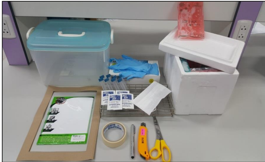
ภาพที่ 4-7 ชุดอุปกรณ์สำหรับการเก็บตัวอย่างฝุ่นตะกั่วบนพื้นผิว
